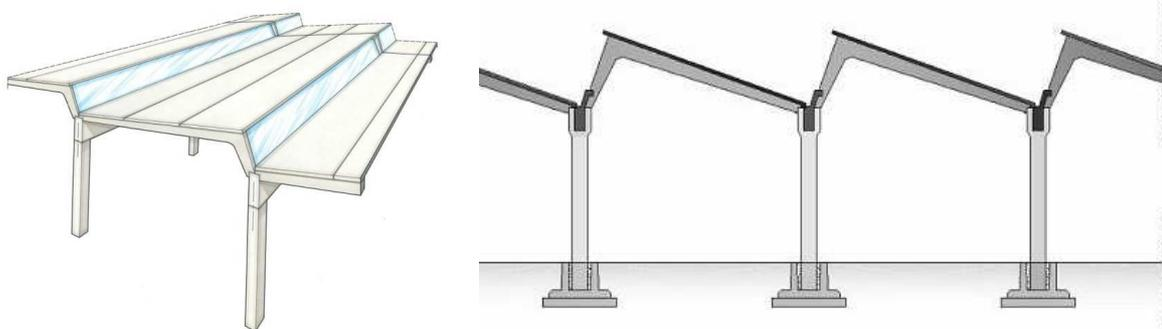
*Figura 7: Sistema monopiano con copertura a shed con trave a ginocchio*
