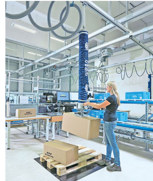
Sistema pneumatico per il sollevamento
