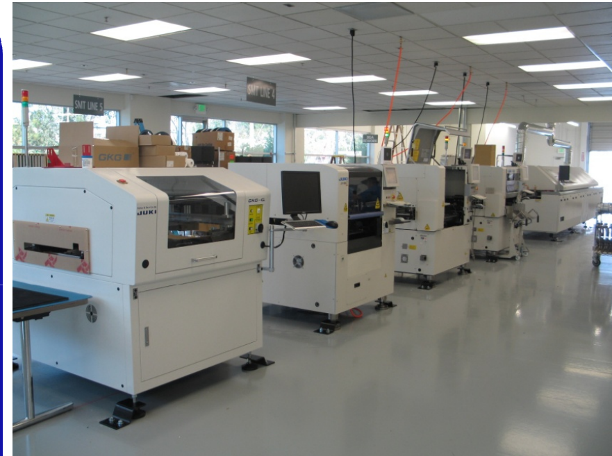
Macchine assemblaggio SMT interconnesso con sistema ERP per fermo macchina o rallentamenti
